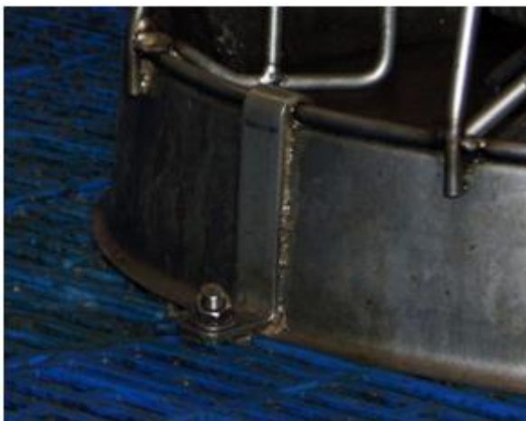
Figuur 1 Bevestiging van de Vewi Feeder aan de roostervloer.
