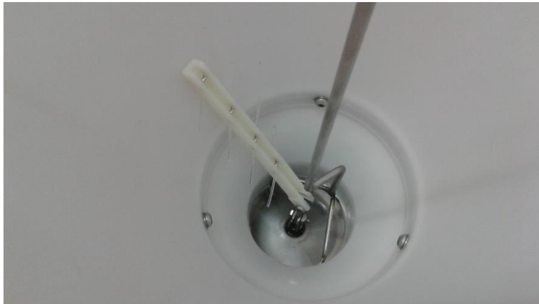
Figuur 5 De spindel aan de binnenzijde van de voorraadbak. Deze kun je verwijderen door het moertje los te draaien.
