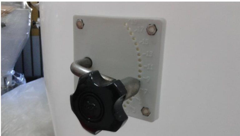
Figuur 4 Het afstellen van de voerhoeveelheid kan met deze knop. Door deze uit te trekken kun je de knop naar boven en onderen verplaatsen.
