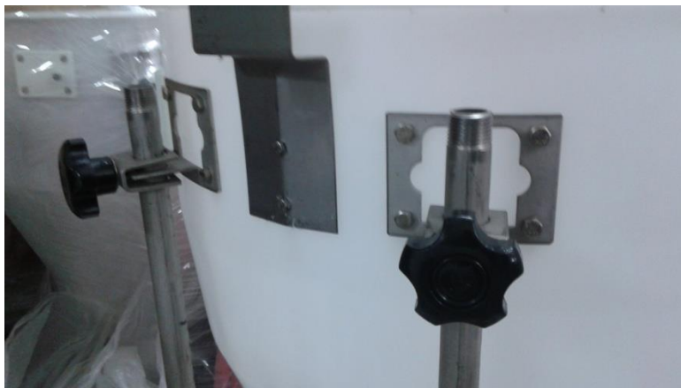
Figuur 2 De drinkwaterleiding is in hoogte verstelbaar. Door beide knoppen los te draaien is de drinkwaterleiding met de hand te verstellen.
